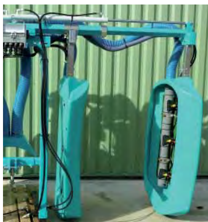
Pulvérisateur DHUGUES avec des panneaux récupérateurs roto moulés utilisant une assistance d'air
